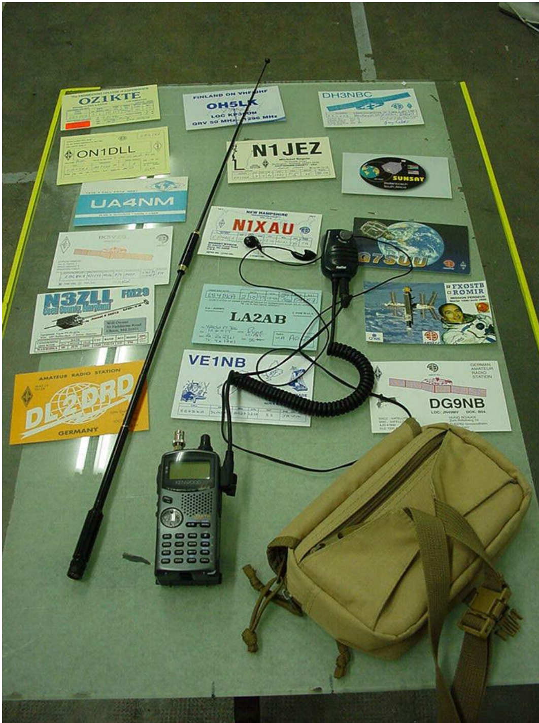
Estación portátil completa para trabajar los satélites de FM.
