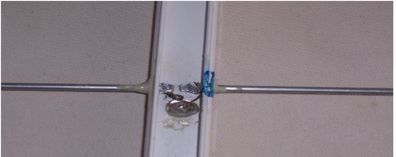
Figura 1 y 2: Canaleta con la tapa quitada y montados los 4 elementos. Se observa las fichas de empalme. En figura 2, la conexión del elemento excitado. Las varillas del elemento excitado, han sido aplanadas para poder hacerle los taladros de fijación a la canaleta y su conexión al conector BNC.
