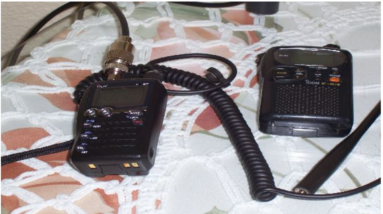
Figura 6: Realicé las pruebas primero con un WT IC-Q7 (350 mlw) y después con IC-E7 (1 W), enlazando con el repetidor de UHF R100 (EC7H) situado en la
