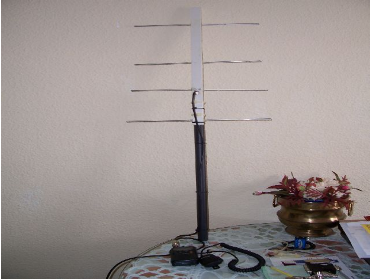
Figura 5: Añadido un tubo de PVC para su manejo.
